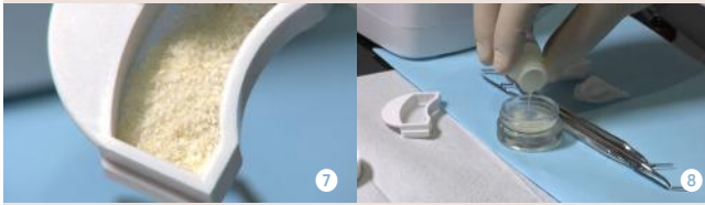
Fig. 7 et 8. Le matériel obtenu, broyé et filtré, est immergé, pendant 10 minutes, dans une solution nettoyante baptisée « Cleanser », qui contient de l'hydroxyde de sodium avec 20 % d'éthanol.
