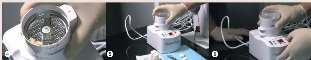
Fig. 4-6. Le compartiment est bien fermé. Le procédé GRIND (BROYER) est ajusté à 3 secondes et SORT (TRIER) à 20 secondes. Le broyage débute en actionnant la commande START (DÉMARRER). Le bruit fort du broyage est suivi d'une vibration qui permet de trier et de collecter les granulats dans les deux compartiments de filtration.
